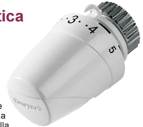
La valvola termostatica regola automaticamente l'afflusso di acqua calda in base alla temperatura scelta ed impostata su un apposita manopola graduata. L'aria dell'ambiente lambisce il sensore della valvola termostatica che chiuderà, a mano a mano che la temperatura ambiente si avvicina a quella desiderata, il passaggio di acqua calda nel calorifero. Quando la temperatura ambiente scenderà al di sotto del valore desiderato, il sensore riporterà la valvola in posizione di apertura.
